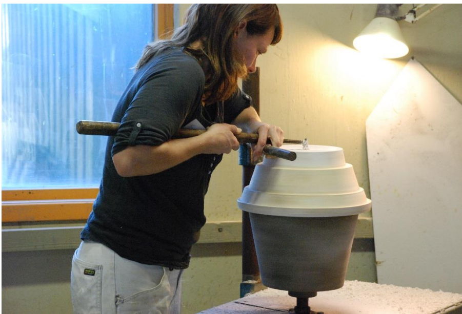
Gipsstøpen er plassert på dreiebenken (spindelen) og dreining av bollens utside er godt i gang. Dreiestålet er laget av fjærstål.
