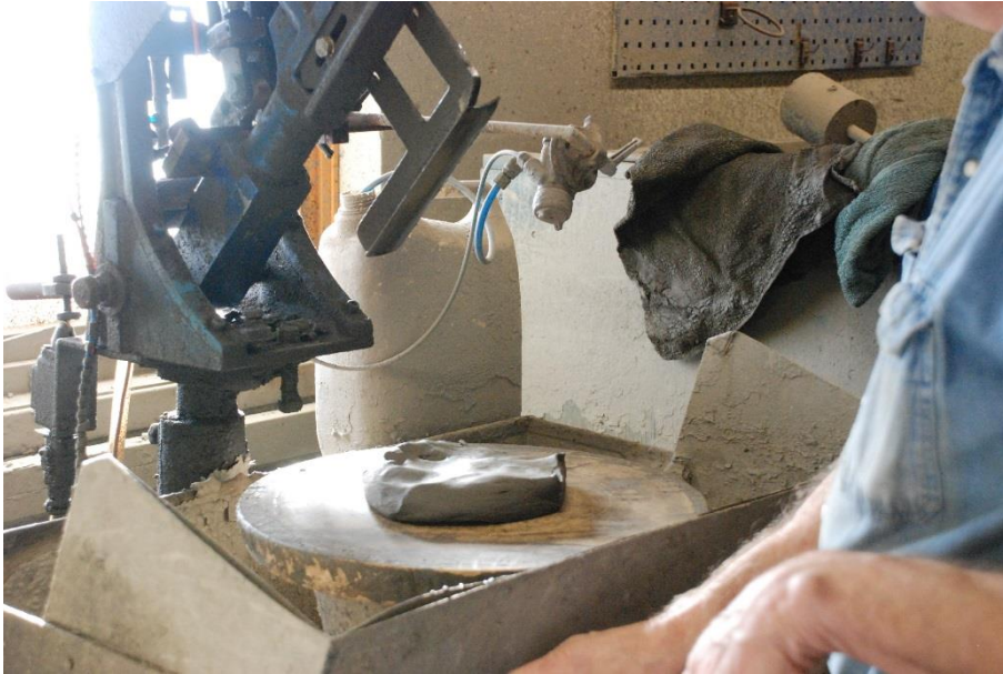
Maskin som dreier ut en leiv av leira. Denne skal brukes til å lage en tallerken.
