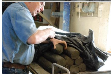
Thor Lannem ved filterpressa. Til høyre øverst ser vi en skive leire tatt ut fra pressa og på neste bilde pølser av leire etter behandling i eltemaskinen.
