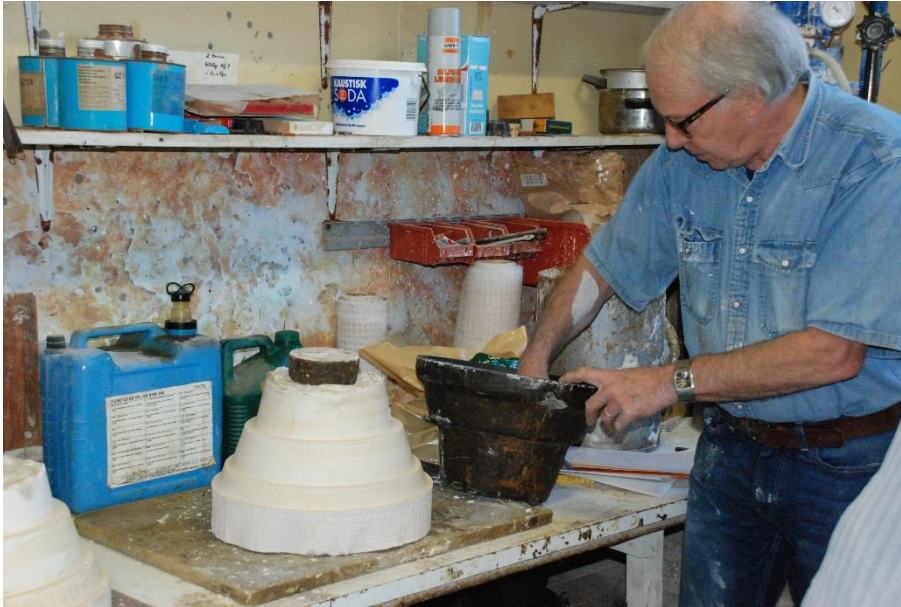
Gipsen har herdet og er tatt ut av støpeformen (klokka).
